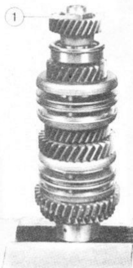
Fig. 6.13 Arbre secondaire (5 vitesses) (Sec 7)
