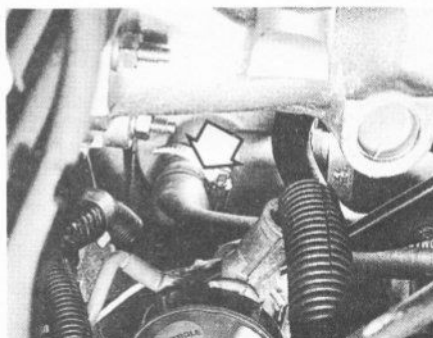
7.43A Raccord (fléché) de durit de dérivation sur boîtier de pompe à eau – moteurs TU
