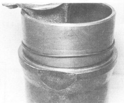
19.10 Joint torique de chemise
