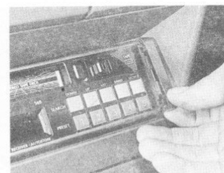
22.54 Dépose des enjoliveurs latéraux de la radio
