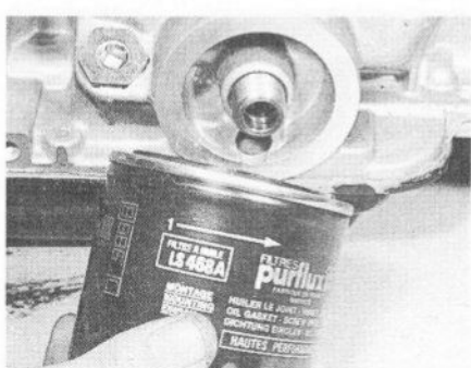
6.53 Dépose du filtre à huile
