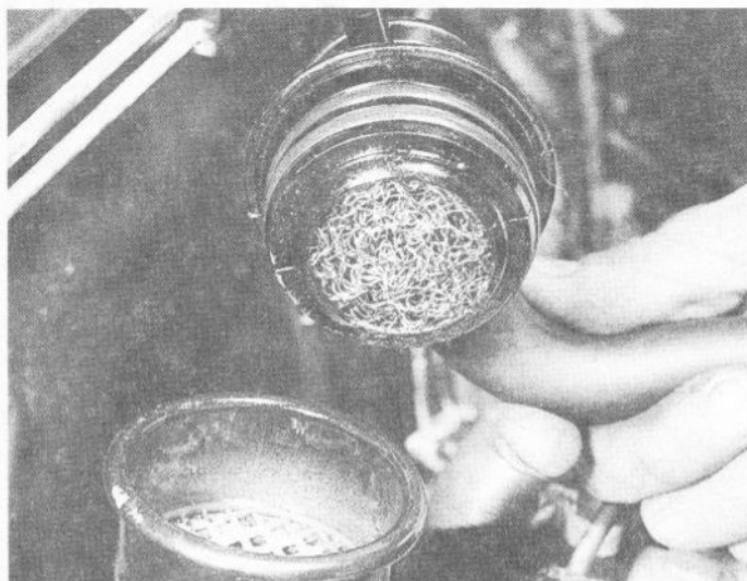
2.14 Bouchon de remplissage d'huile (sauf GTI) et filtre grillagé
