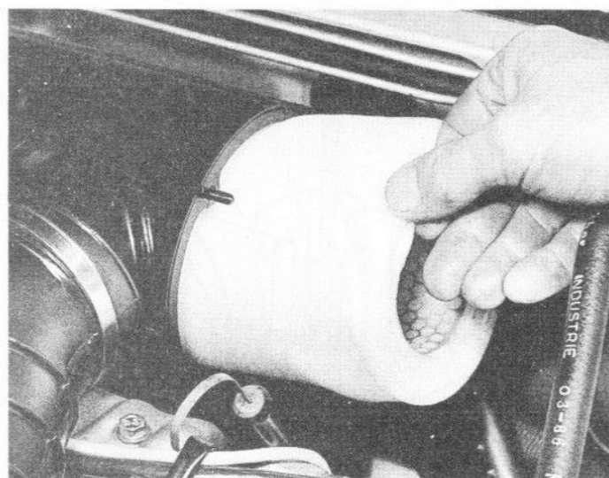
18.3 Dépose de l'élément filtrant *
