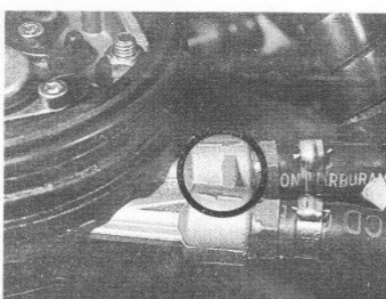
9E.45 Repères de sens d'écoulement d'essence sur le boîtier de papillon – système Mono-Jetronic A2.2
