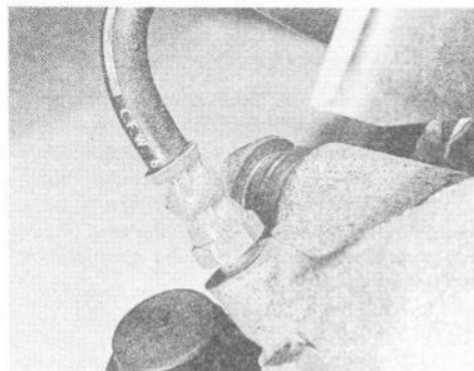
17.45 Raccord et flexible de frein d'étrier arrière
