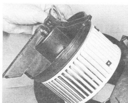
23.7B ... et déposer le ventilateur
