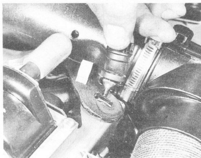
8.38 Attache spéciale maintenant le conduit d'admission d'air sur le support de la bobine d'allumage - moteurs TU
