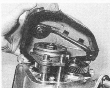
14.29B ... et déposer le carter en acier embouti
