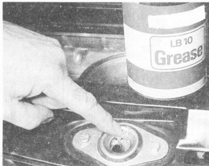
21.123 Graissage de la serrure du capot
