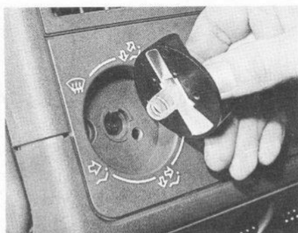
21.93 Dépose d'un bouton de commande de chauffage
