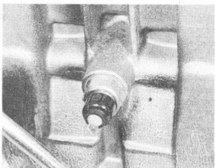
6.54 Manocontact de pression d'huile
