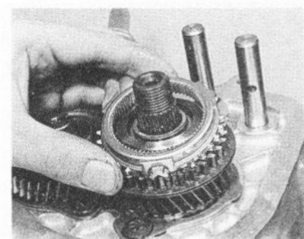
14.34A Dépose de la bague du synchroniseur de 5ème ...
