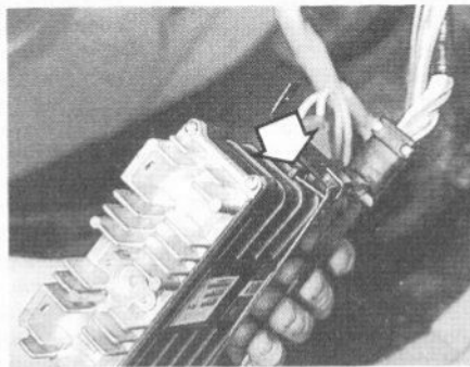
9A.18B Dépose du calculateur électronique de son support. Noter la présence d'un ergot d'arrêt (flèche)
