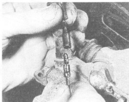
3.3B Débranchement du fil d'usure de plaquette
