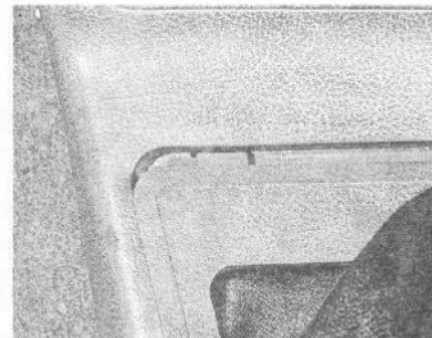
3.3C Dépose de l'entourage du levier de changement de vitesse
