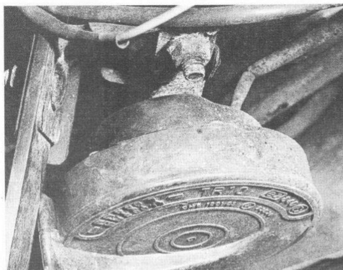
31.3 Avertisseur et écrou de fixation
