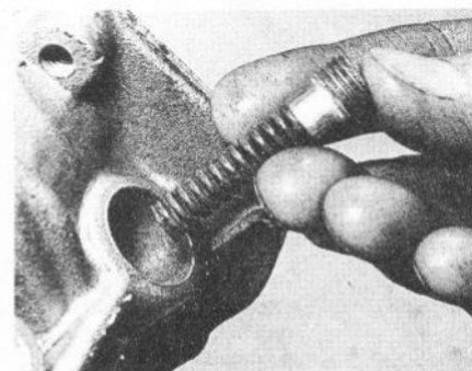
8.36B Ressort de bille de verrouillage et bouchon
