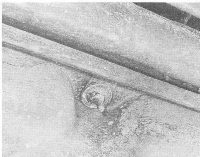
8.6 Boulon de fixation du réservoir de carburant
