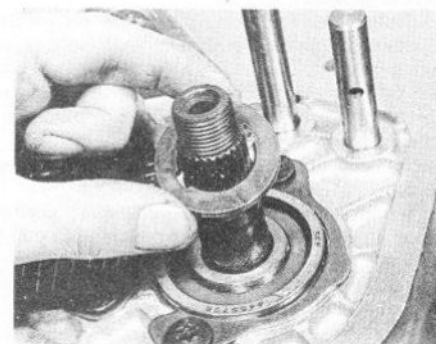
14.34E ... et de la rondelle de butée
