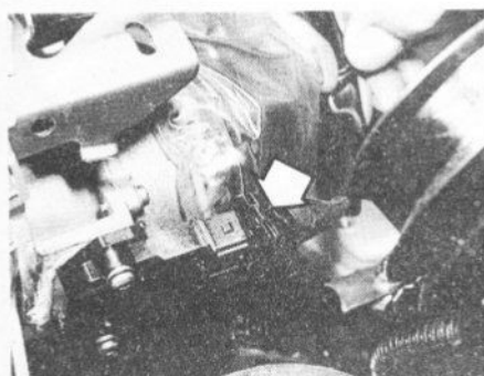
10.16 Débranchement du connecteur de câblage d'allumeur (fléché) – moteurs TU
