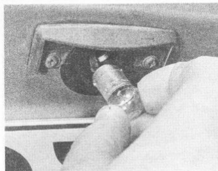
19.17 ... et sortir l'ampoule
