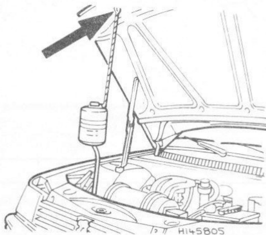
Fig. 2.3 Attacher la boîte de dégazage au cours du remplissage du circuit de refroidissement (Sec 3)
