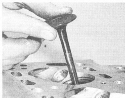
14.3C Dépose de la soupape
