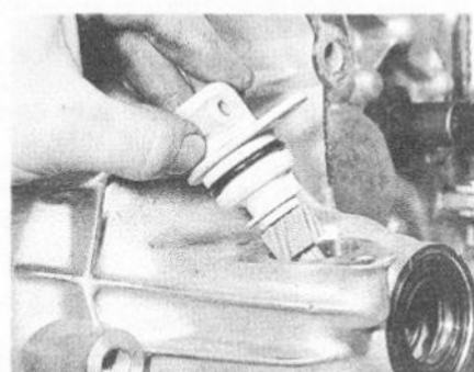
14.28B ... et déposer le pignon de commande du compteur de vitesse – boîte de vitesses MA
