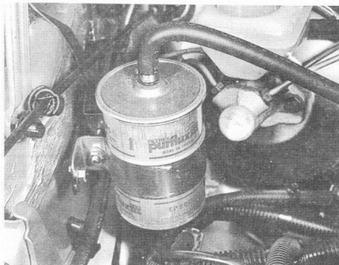
9E.12 Emplacement du filtre à essence – système Mono-Jetronic A2.2 (modèle avec conduite à droite – les modèles avec conduite à gauche sont semblables)
