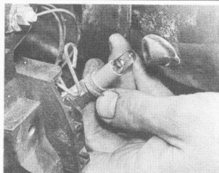
19.6 Dépose du porte-ampoule de feu de position
