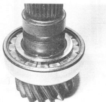
17.4C ... et le jonc d'arrêt du roulement
