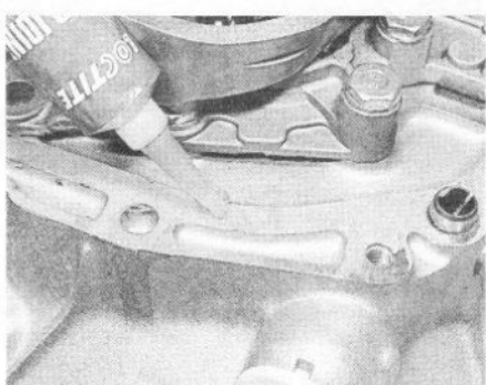
14.113 Placer du produit d'étanchéité sur le carter d'embrayage/différentiel
