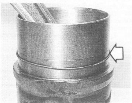
6.83 Joint torique inférieur de chemise (flèche)
