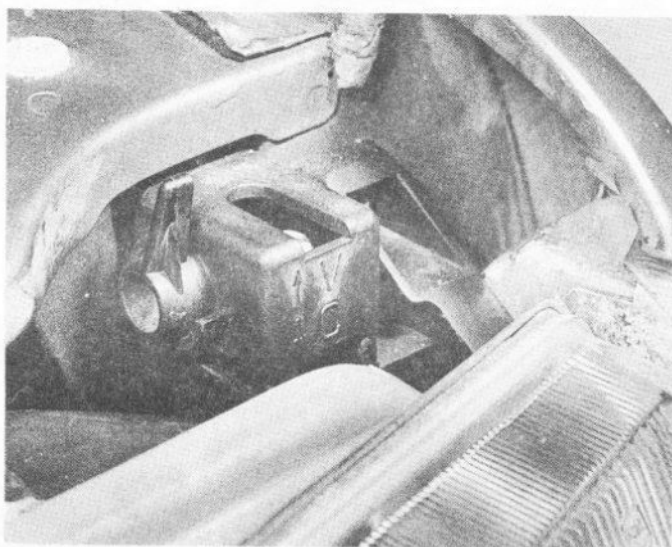
22.2 Levier de réglage de hauteur de phare
