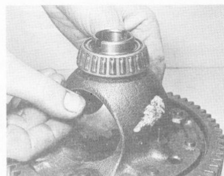
19.2 Dépose de planétaire de différentiel
