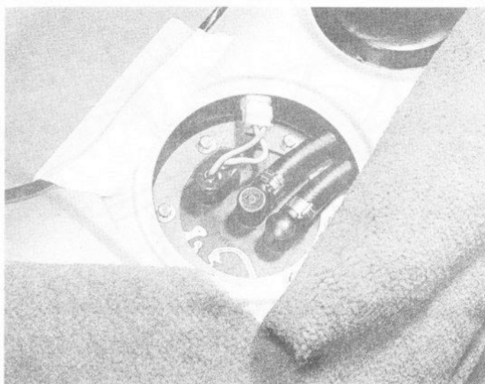
24.2 Position de la pompe à essence et connexions
