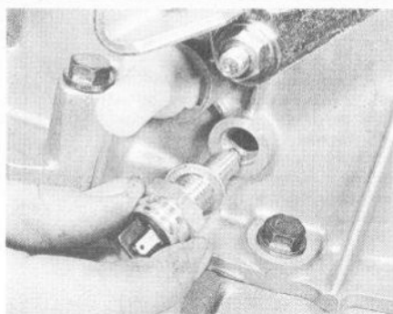
22.59 Dépose du contacteur des feux de recul
