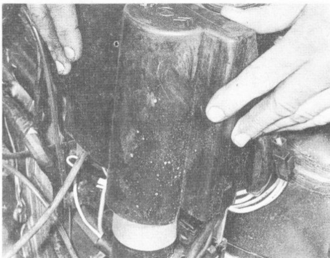
5.1 Dépose du couvercle de bobine et de module
