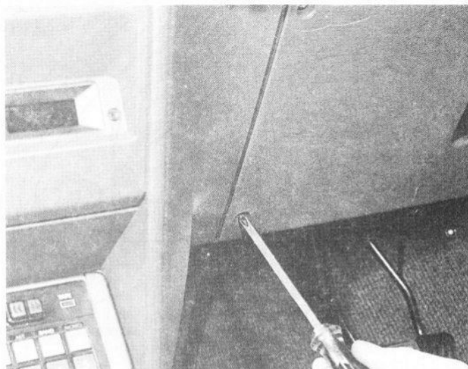
21.89 Dépose d'une vis de maintien du panneau inférieur droit (modèle avec conduite à droite – les modèles avec conduite à gauche sont semblables)
