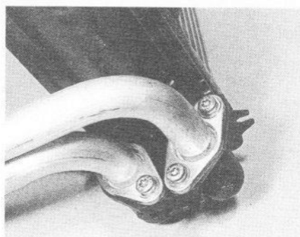
23.6C Tuyaux et brides du radiateur
