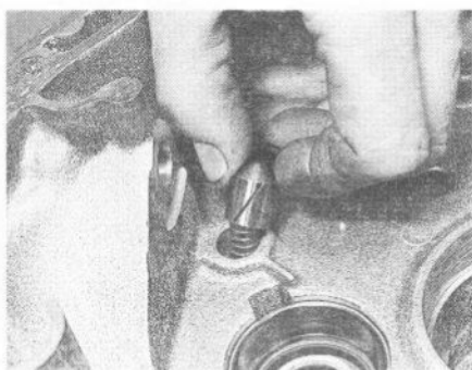
14.26B Plongeur et ressort de verrouillage de marche arrière
