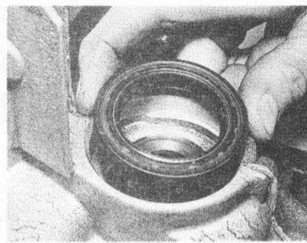
10.21 Joint d'huile d'arbre de roue de la boîte
