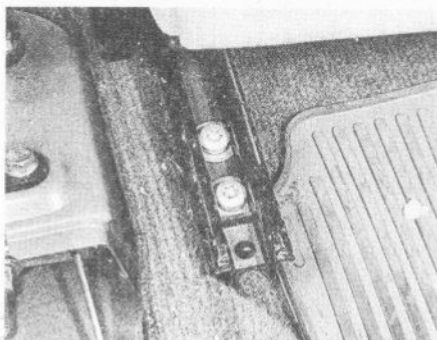
18.1 Boulons intérieurs arrière du siège avant
