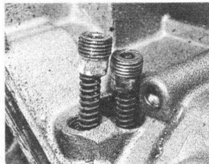
8.36C Position des deux autres ressorts de bille de verrouillage et bouchons
