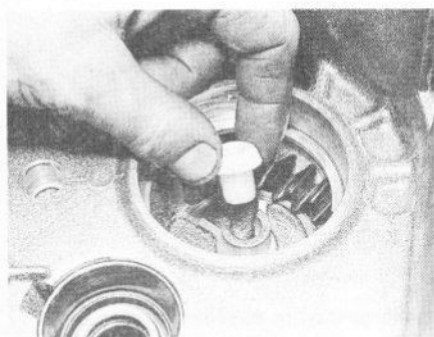
20.16 Pose du gicleur de graissage
