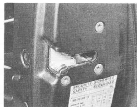
13.3A Serrure de porte et vis de maintien
